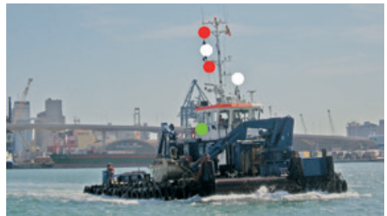
Fig. 33a. Luces de buque con capacidad de maniobra restringida (menos de 50 m de eslora)
