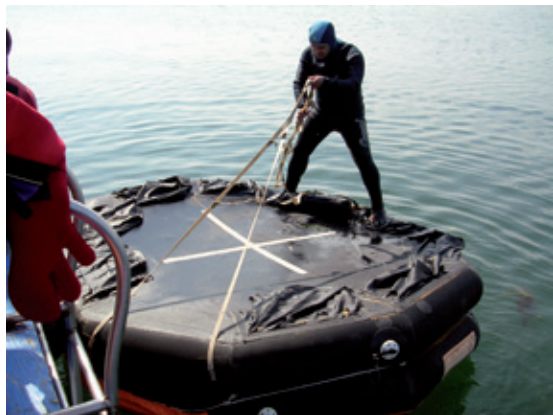
Fig. 14. Adrizamiento de una balsa salvavidas
