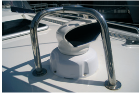
Fig. 6. Manguerotes de ventilación
