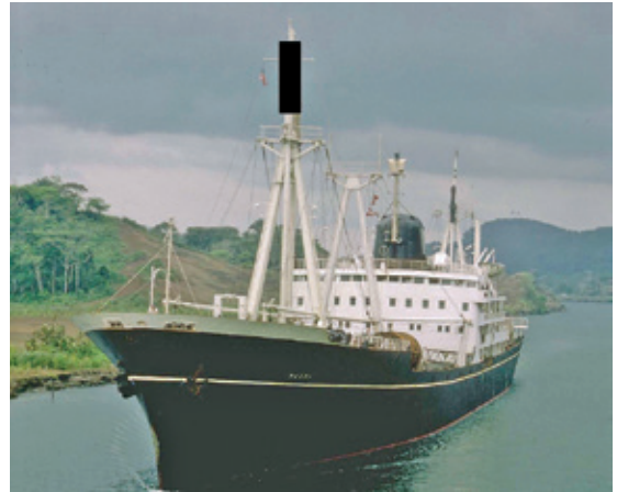
Fig. 39. Marcas de buque de propulsión mecánica restringido por su calado
