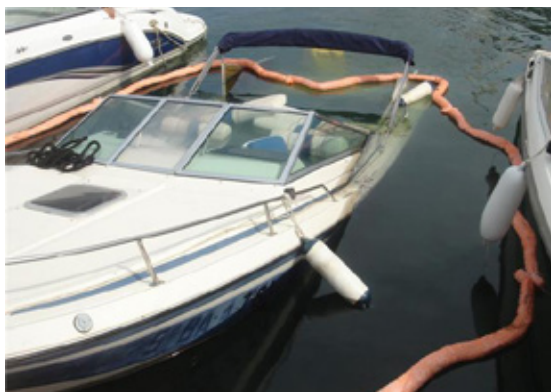
Fig. 9. Barrera de contención de hidrocarburos
