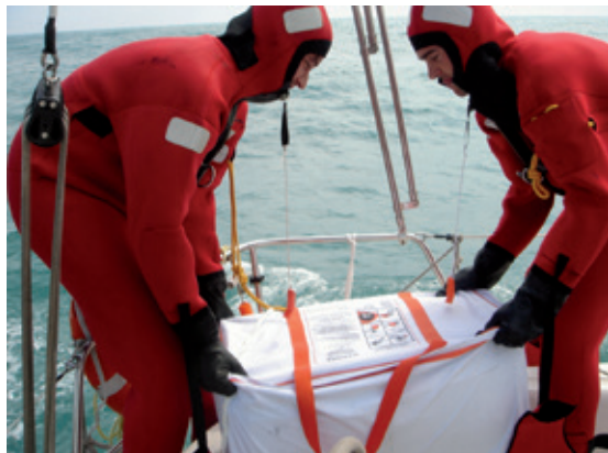
Fig. 13. Trincado de la balsa para no perderla
