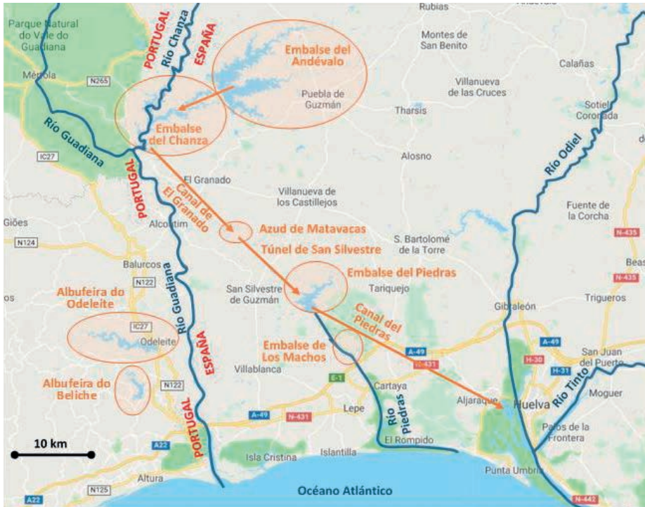
FIGURA 2: Esquema del sistema de recursos hídricos de la cuenca internacional del Bajo Guadiana con cuatro embalses de regulación: Andévalo, Chanza, Odeleite y Beliche. Se representa el esquema hidráulico del sistema de regulación Chanza-Piedras-Huelva para la distribución de la demanda consolidada de agua que se transfiere a la Demarcación Hidrográfica Tinto-Piedras-Odiel (Pulido-Calvo et al., 2018a)
