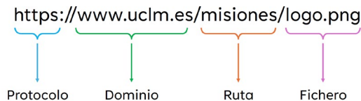
Figura 4.13. La URL https://www.uclm.es/misiones/logo.png se descompone en cuatro partes: el protocolo de acceso seguro ( https ), el dominio ( www.uclm.es ), la ruta que indica la ubicación del recurso en el servidor ( /misiones/ ), y finalmente el fichero específico solicitado ( logo.png ).
