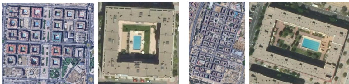
Valdelasfuentes, Alcobendas 68 h, 3.398 v. 23 MC cuadradas, 60x60, patio 35x35, B+4 y+5, crujía 12
