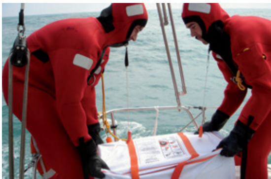
Fig. 23. Trincado de la balsa para no perderla
