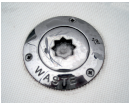
Fig. 9. Conexión universal a tierra para la descarga de vertidos de aguas sucias
