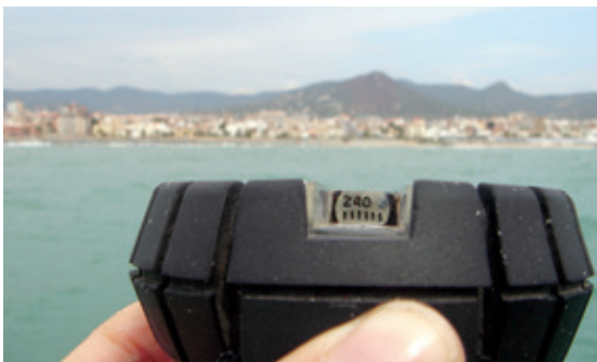
Fig. 10. Forma de encontrar una demora de aguja con un compás de demora
