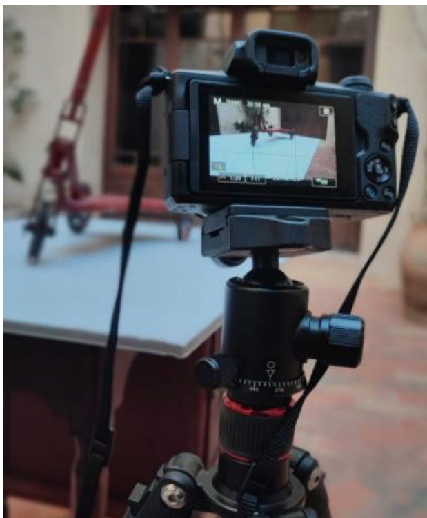
Fig. 7. Cámara tomando fotografías del juguete para la fotogrametría.
