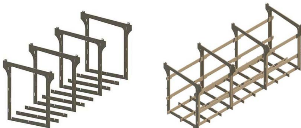
Fig.4 Proceso de modularización del espacio habitable y fase inicial de montaje del forjado, y estabilización de la estructura (8,5 x 3 m), encaje de las correas horizontales y montaje de la estructura de muros, 2014. Fuente: Rafa Perea
