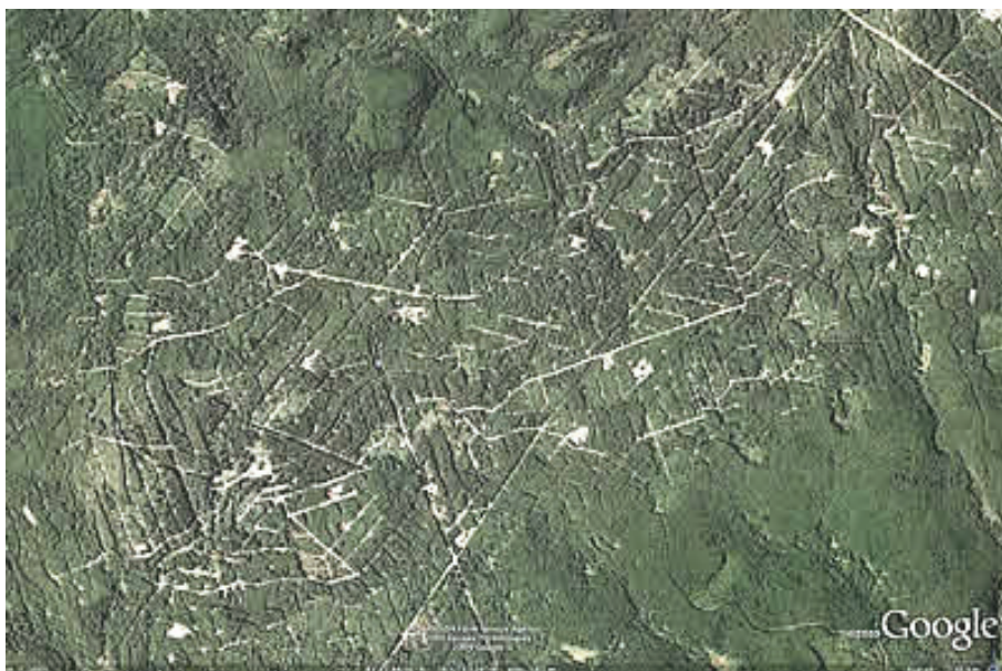
Figura 7.7. Vista aèria del parc Allegheny, Estat de Pennsylvania (EUA) a finals de 2009, on es veuen els pous, les carreteres i altres instal·lacions relacionades amb l'explotació de jaciments de gas natural no convencional.
