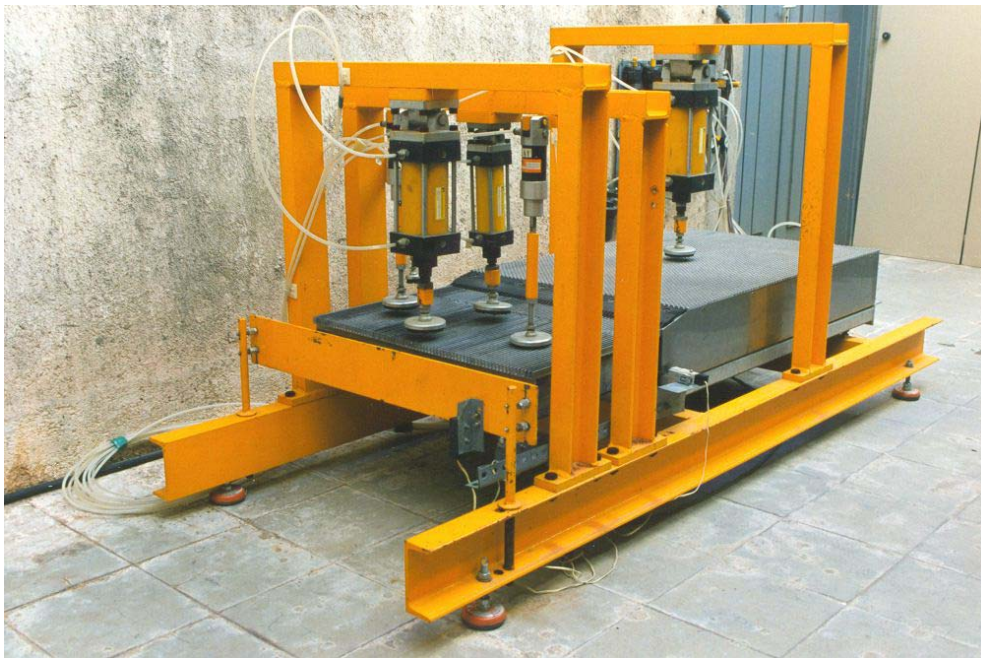
Figura 15.8 Producte fabricat en petita sèrie: mòdul d'andana de geometria variable mòdul i banc d'assaig (Ferrocarriis Generalitat de Catalunya S.A.)
