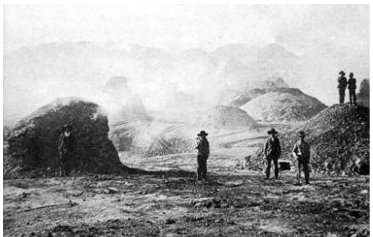
Figura 3.11: Teleras para la tostación de piritita a cielo abierto en la segunda mitad del siglo XIX (Fundación Riotinto).
