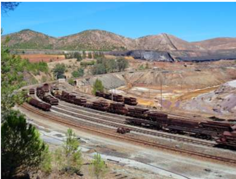
Figura 4.9: Izquierda: Río Tinto en la zona de Zarandas-Naya, donde se realizaba antiguamente el tratamiento del mineral y se cargaba en trenes para transportarlo hasta el puerto de Huelva. En esta zona existen una gran cantidad de residuos abandonados, ricos en sulfuros, que producen lixiviados muy contaminantes. Derecha: Detalle de lixiviados ácidos junto con una gran cantidad de sales evaporíticas precipitadas durante el verano.
