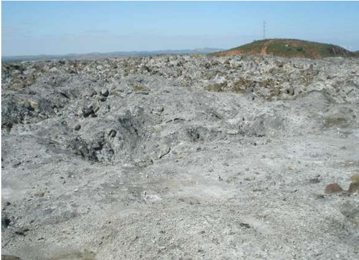
Figura 2.4: Escombreras de sulfuros en la zona de Filón Sur (Tharsis). El agua de las precipitaciones se infiltra disolviendo los sulfuros (obsérvense las pequeñas dolinas de disolución) y genera lixiviados ácidos con un gran potencial contaminante que surgen por su base.
