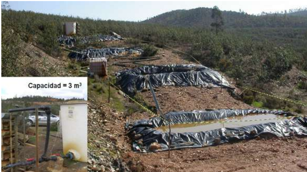
Figura 7.20: Planta piloto de tratamiento DAS de aguas ácidas instalada en la mina Monte Romero.
