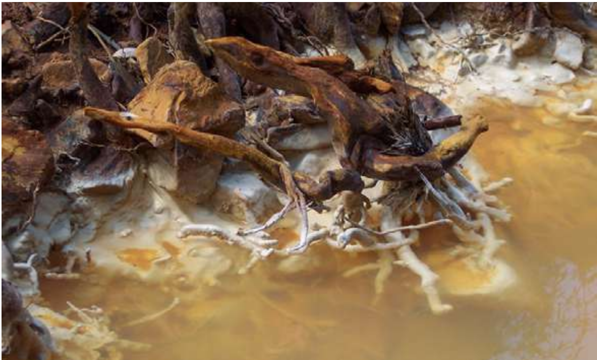
Figura 2.13: Precipitación de yeso sobre raíces en el arroyo de Batán. Este arroyo tiene una elevada concentración de calcio debido al tratamiento de neutralización de los lixiviados ácidos que se realiza en Minas de Almagrera.
