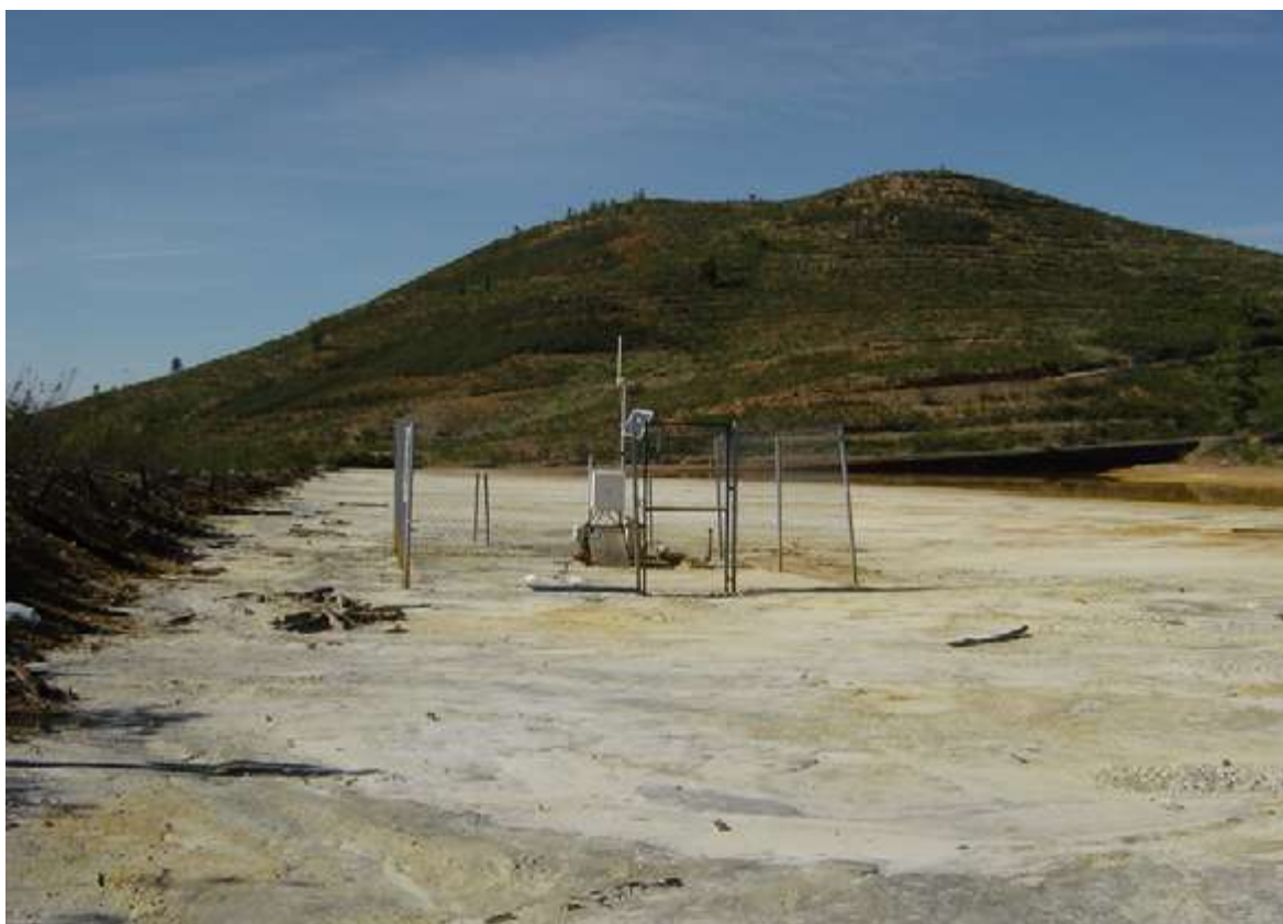
Figura 2.7: Balsa de lodos de las minas de Cueva de la Mora, donde se instaló en el año 2008 una estación experimental para la investigación de los procesos de oxidación de sulfuros. Esta balsa se restauró posteriormente y actualmente está sellada con materiales impermeables.
