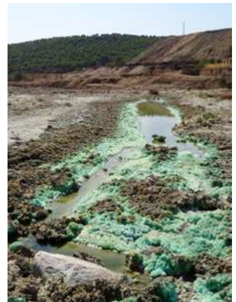
Figura 4.9: Izquierda: Río Tinto en la zona de Zarandas-Naya, donde se realizaba antiguamente el tratamiento del mineral y se cargaba en trenes para transportarlo hasta el puerto de Huelva. En esta zona existen una gran cantidad de residuos abandonados, ricos en sulfuros, que producen lixiviados muy contaminantes. Derecha: Detalle de lixiviados ácidos junto con una gran cantidad de sales evaporíticas precipitadas durante el verano.
