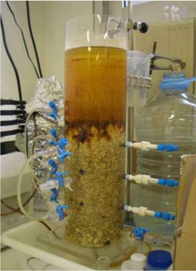
Figura 7.19: Columna rellena de material reactivo para el diseño del tratamiento de drenajes ácidos de mina. El flujo se efectúa de arriba abajo. Se observan los precipitados que se producen en el contacto del material reactivo con el agua ácida.
