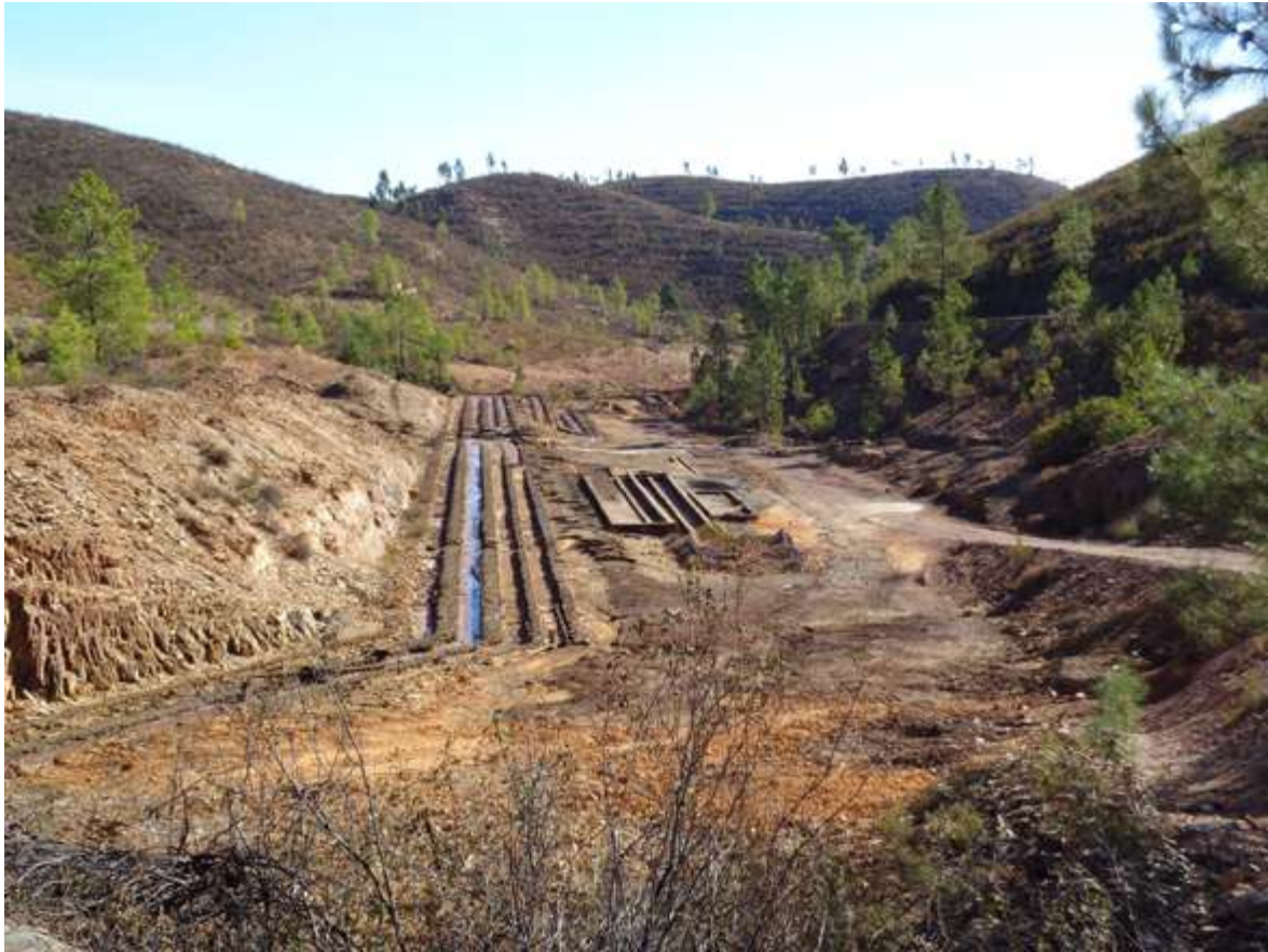
Figura 3.12: Sistema de canaleo en la mina de La Zarza que se estuvo empleando hasta los años 60 del siglo pasado.
