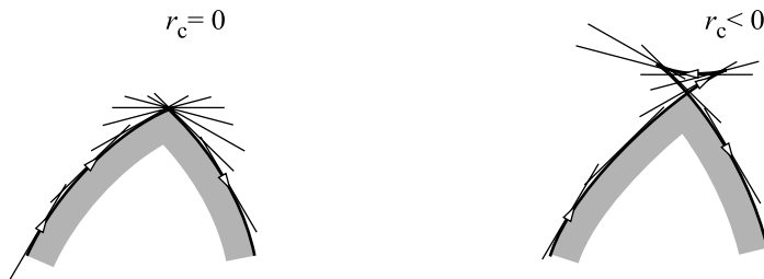
Fig. 4.20 Possibles problemes del perfil d'una lleva amb palpador pla
