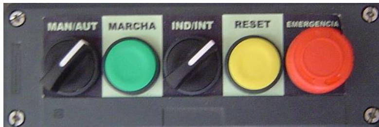
Fig. A.1 Panel de mando académico únicamente formado por controladores sin la presencia de dispositivos informativos visuales DIV
