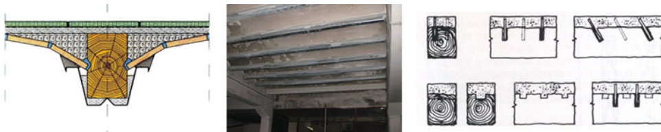
Fig. 18.6. En el gráfico izquierdo y la foto, refuerzo o sustitución funcional de vigas o viguetas de madera con un sistema industrializado de chapa plegada de acero. El contacto se asegura rellenando con mortero tixotrópico la interfase entre la vigueta y la chapa de refuerzo. En el gráfico de la derecha, refuerzo por la parte superior con mortero epoxídico conectado a la viga o vigueta con cilindros de fibra de vidrio.
