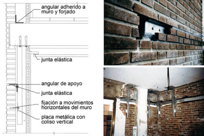
Fig. 36.4. Formación de junta elástica horizontal y disposición de angular de apoyo en la línea de dinteles mediante la extracción y reposición de dos hiladas de ladrillo. Los tubos de sujeción del angular se prolongan verticalmente hacia abajo para prever puntos de fijación que evitan el vuelco del muro, pero permiten su libre desplazamiento vertical.
