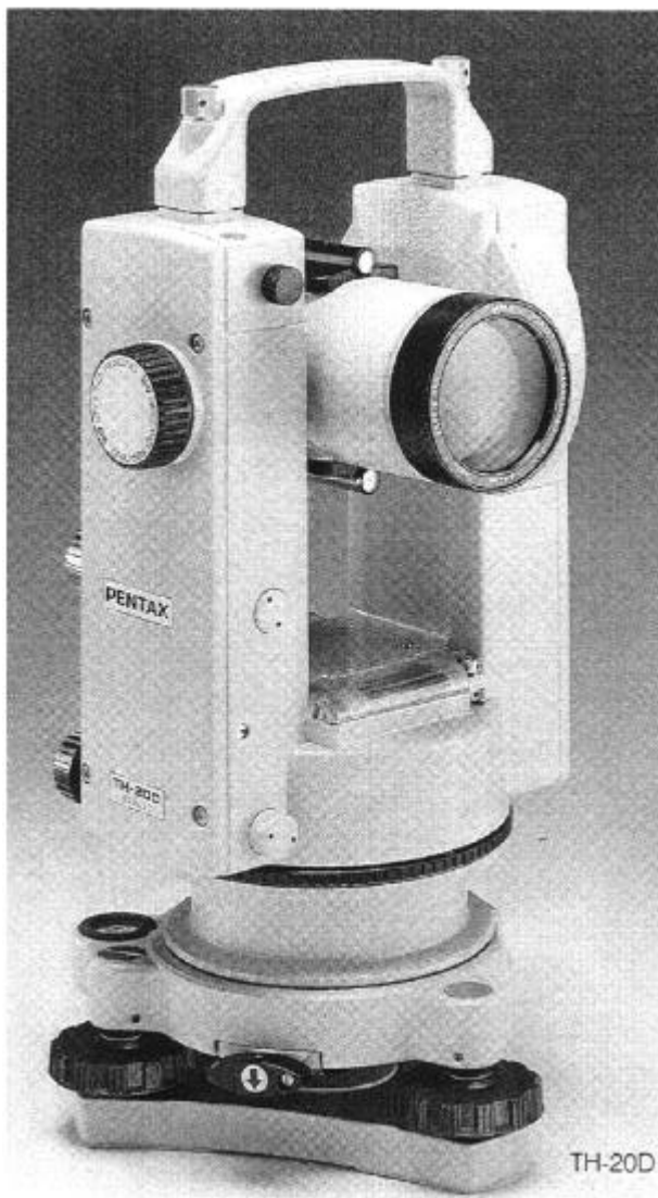
Fig. 9.11 Taquímetre TH-20D, de la casa Pentax
