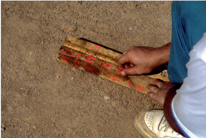
Fig. 100 Apuntando manualmente el número de golpes sobre una estaca arrancada!.
