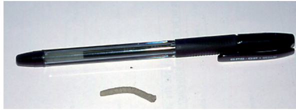
Fig. 48 Bastoncillo de 3 mm de diámetro que se forma para determinar el límite plástico.
