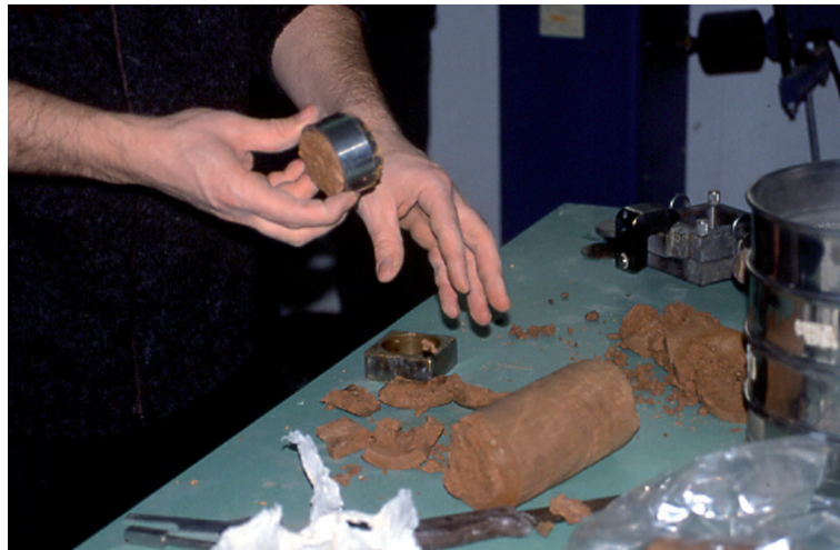
Fig. 131 El técnico de laboratorio prepara el ensayo con una muestra inalterada. A partir de la muestra que hay encima de la mesa, se pueden hacer más ensayos.
