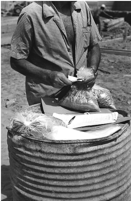
Fig. 191 (Izq.) La muestra del SPT es alterada.
