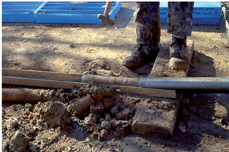
Fig. 187 La muestra sale alterada del tubo de sondeo.
