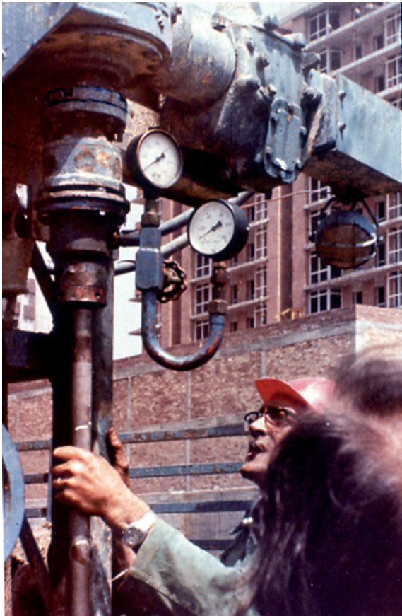
Fig. 80 Penetrómetro estático acoplado a un camión de geotecnia.
