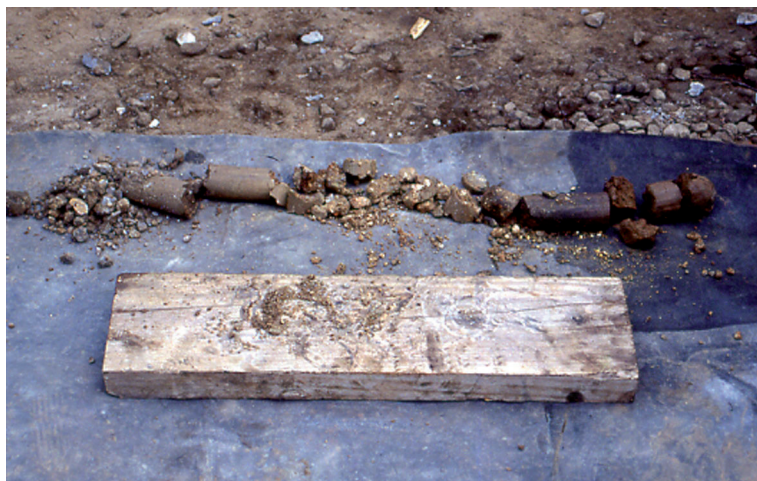
Fig. 188 La longitud de la muestra continua depende de la manipulación.
