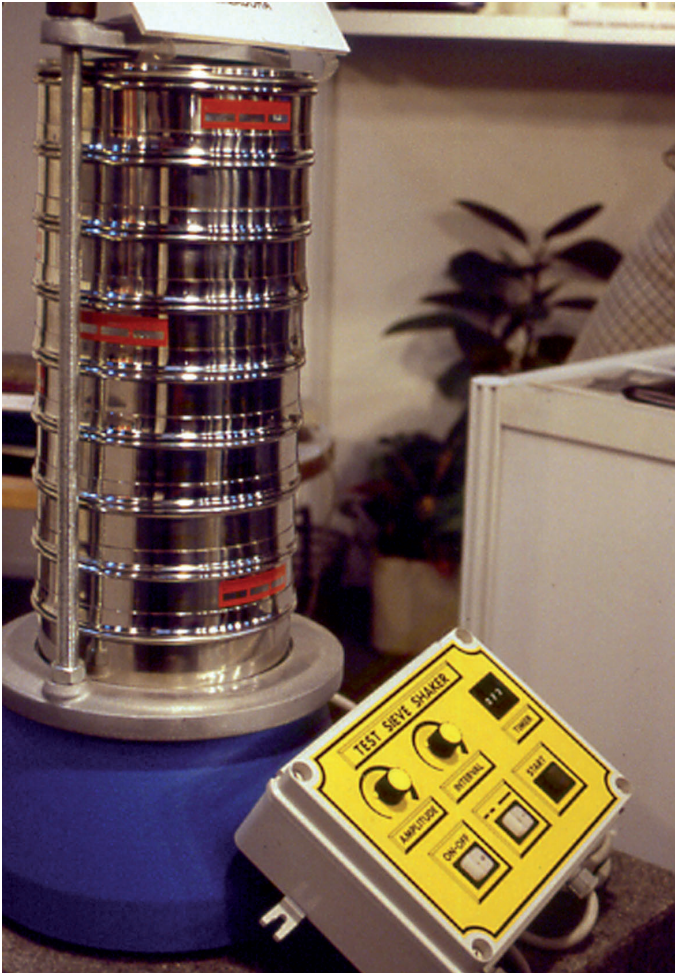
Fig. 42 Ensayo de granulometría. En la parte superior, se coloca el tamiz más grueso, de modo que los granos van quedando retenidos en función de su diámetro.
