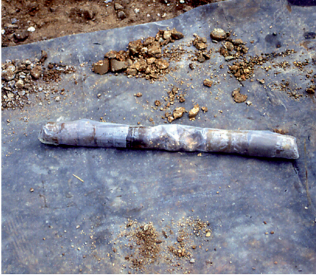
Fig. 189 (Izd.) Tramo de la muestra alterada envuelta para enviarla al laboratorio. La categoría de la muestra es C (alterada/representativa), que servirá para identificar el suelo (descripción visual, granulometría y límites) y determinar la materia orgánica, el carbonato o el contenido de sulfatos.
