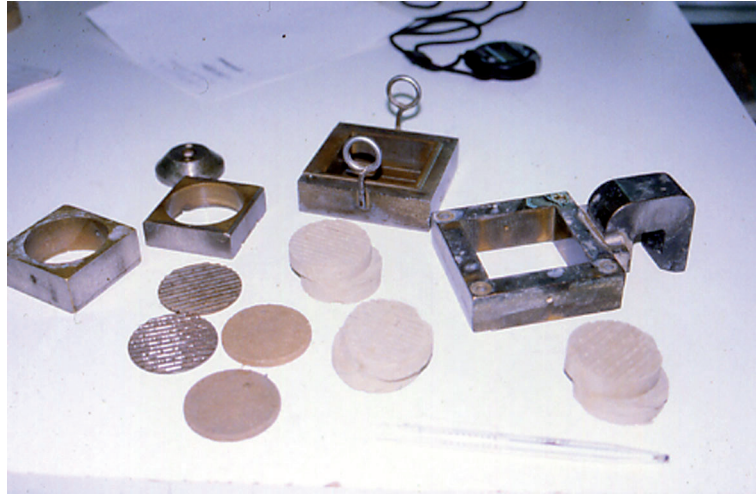
Fig. 130 Caja de corte desmontada. Las placas porosas son para drenar y acelerar el ensayo.
