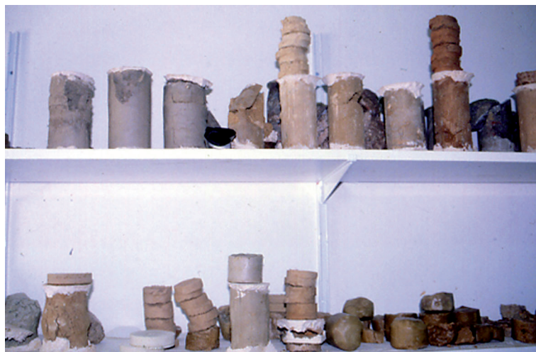
Fig. 132 Las pastillas son muestras ensayadas al corte y los cilindros, a la compresión simple.
