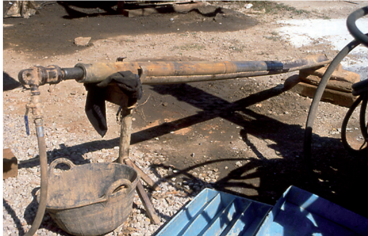
Fig. 186 Si la muestra no sale a golpes de mazo, se inyecta agua a presión y aún se altera más.
