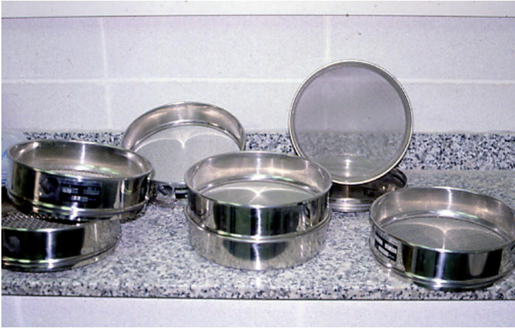
Fig. 41 Los tamices normalizados para identificar los suelos granulares.
