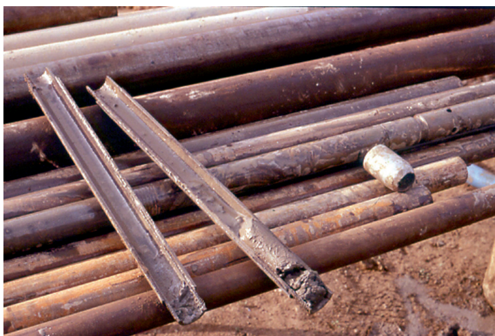
Fig. 104 Este ensayo también es nulo porque, al abrir el SPT, se comprueba que una concreción lo ha atascado, con un resultado muy superior al que corresponde a los limos orgánicos de la Vermeda, donde se ha realizado.
