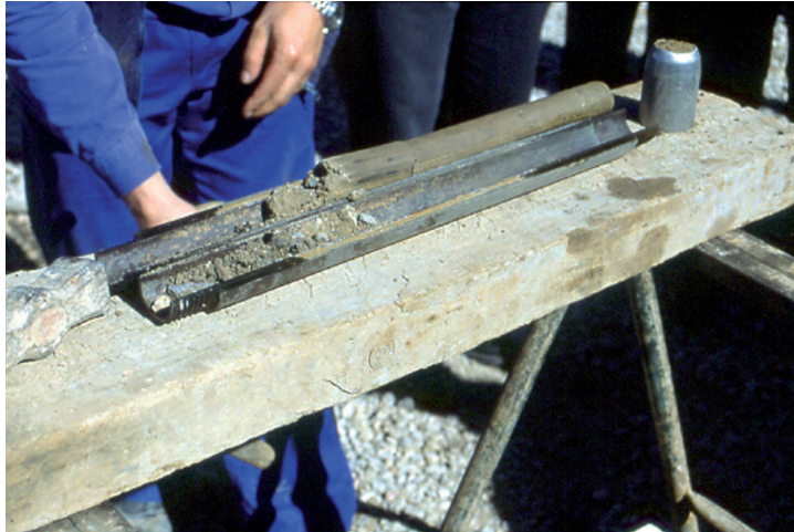
Fig. 102 SPT abierto. A la derecha, la punta roscada.
