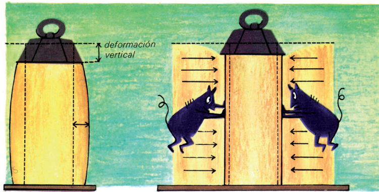
Fig. 140 El confinamiento incrementa la resistencia (Fuente: R. L'Hermite, 1971).
