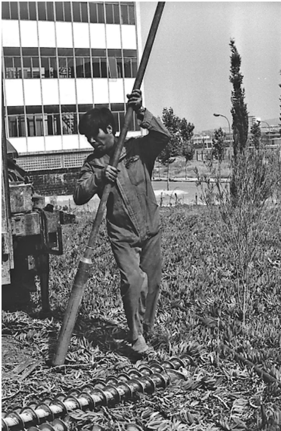
Fig. 180 Extracción del tubo de sondeo con el tomamuestras de muestras inalteradas (Fuente: ETSAB, 1979).
