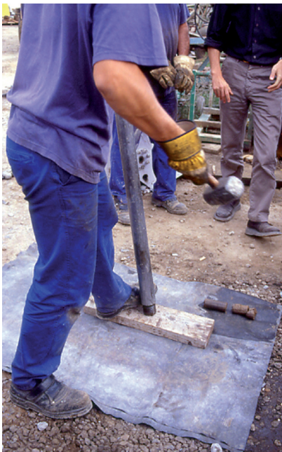
Fig. 184 Extracción de la muestra continua del sondeo a golpes de mazo 1.
