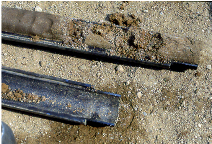
Fig. 103 Penetrómetro abierto después del ensayo: 18 + 8 + 10 + Fig. 16 El trozo de 8 es arcilloso: al presionar con el dedo, queda marcado. El trozo de 18 es arena compacta: al presionar con el dedo, se deshace. El ensayo debe considerarse nulo porque ha coincidido con el cambio de estrato.
